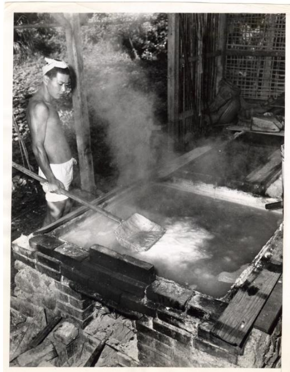
Figura 8. Evaporación de la salmuera en bandejas de hierro calentadas por fuego directo. Octubre de 1947. Fotografía de Richard C. Ferguson. Colección M. Calvo.
