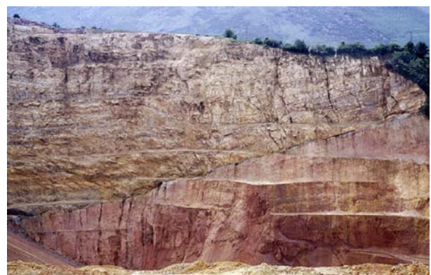
FIGURA 1. Mina de oro de El Valle-Boinás, Belmonte (Asturias). Cabalgamiento de las dolomías de la Formación Láncara sobre las areniscas de la Formación Oville. Foto M. Calvo
